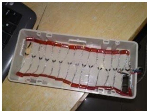
3.1 - сурет – Ионизатордың электрлік сұлбасының жалпы бейнесі
